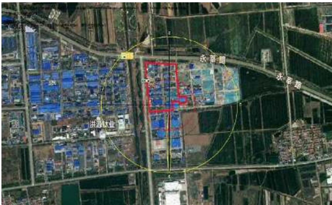
图 12.5-7(c) 二氯乙烷储罐泄漏火灾事故次生氯化氢浓度超过阈值的最大轮廓图
