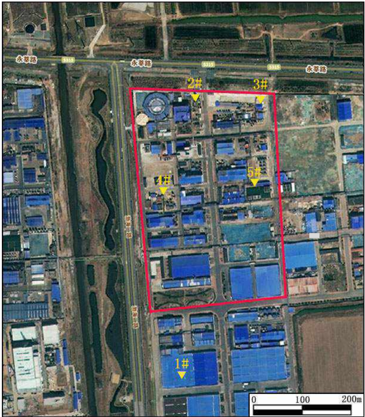
图 7.5-2 厂区地下水监控井分布图
