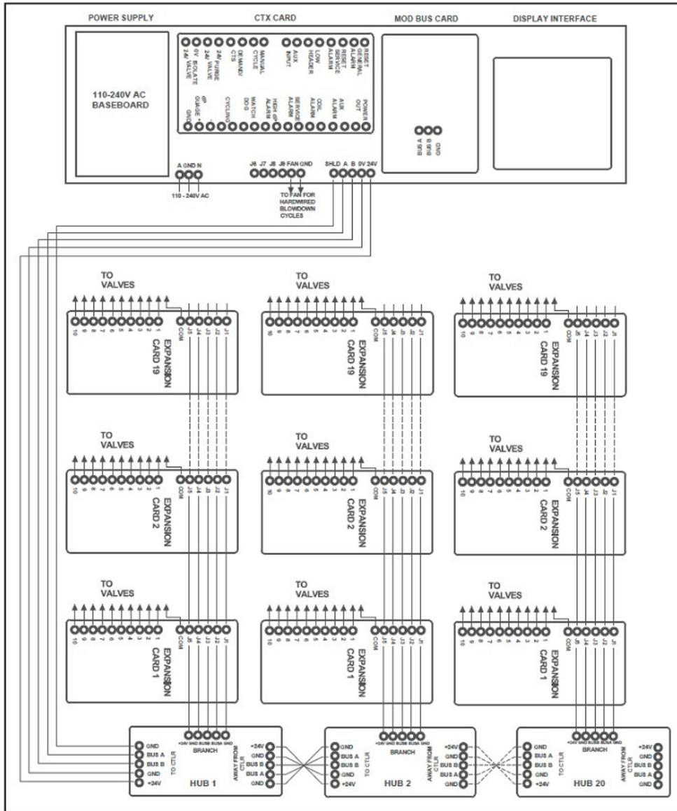
连接风机停机讯号，启动吹净功能：[或连接远程启动喷吹开关](#)
