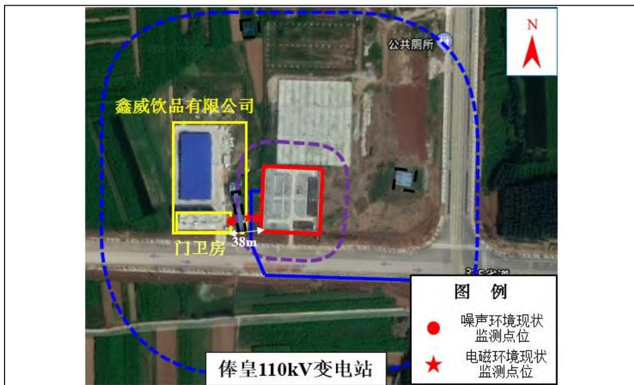
图 19：110kV 俸皇变电站及周围环境保护目标处监测布点图
