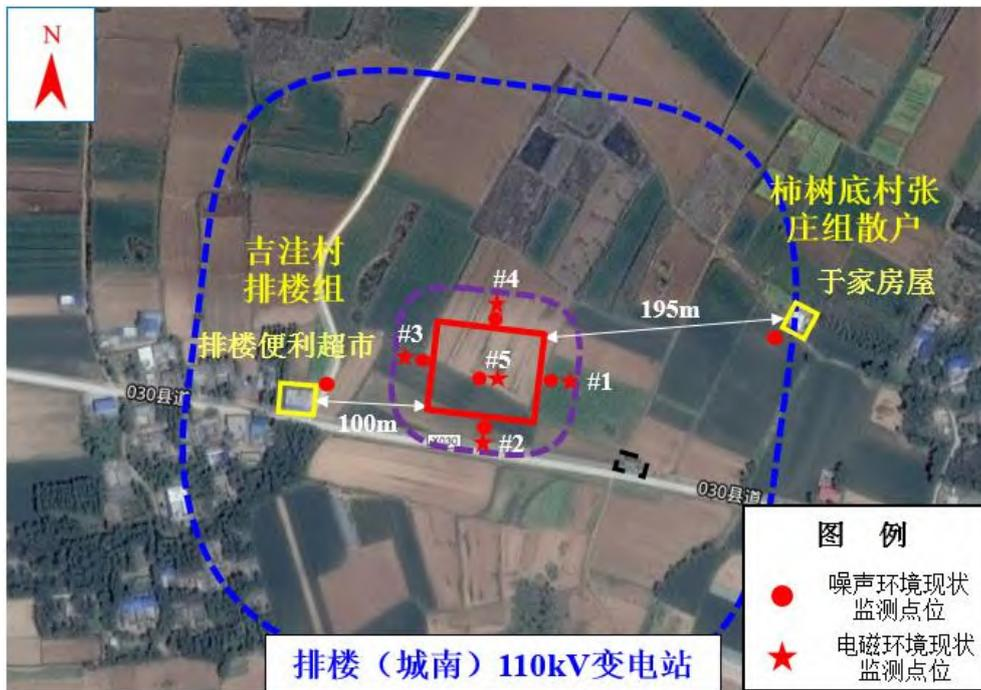
图 17: 110kV 排楼（城南）变电站及周围环境保护目标处监测布点图
