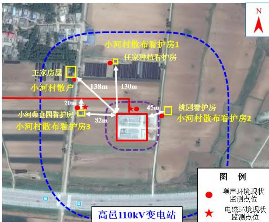
图 18: 110kV 高邑变电站及周围环境保护目标处监测布点图
