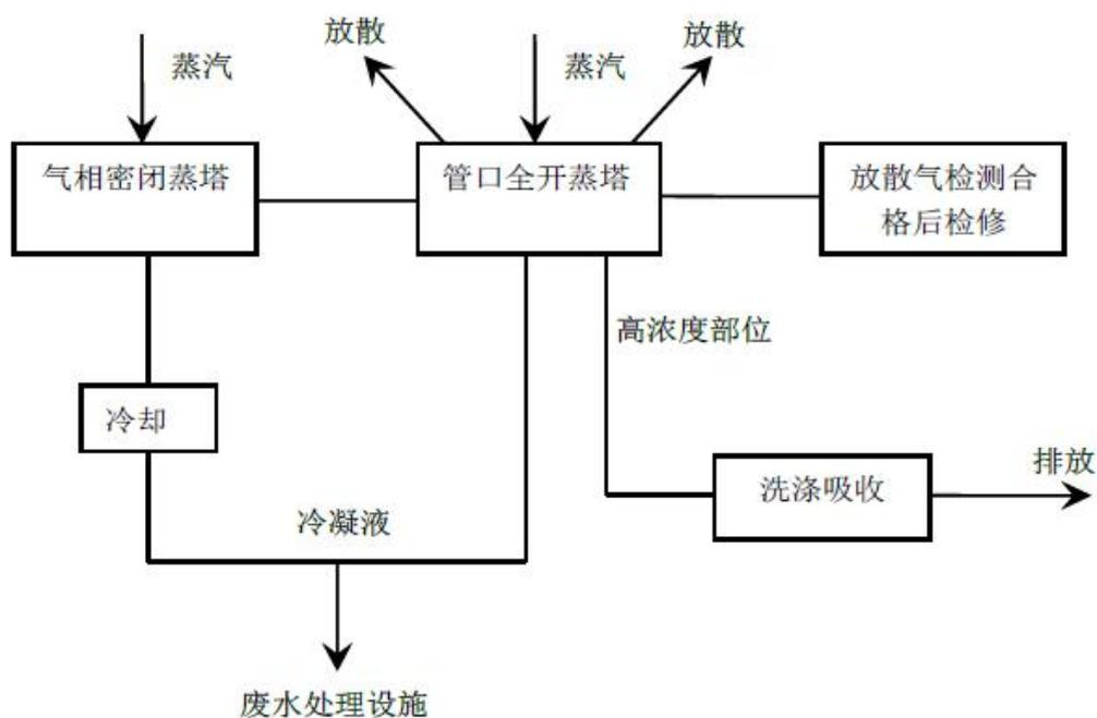
图4 水溶性物料装置吹扫流程图
