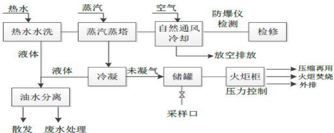
图1 水洗、蒸汽蒸塔倒空吹扫流程示意图
