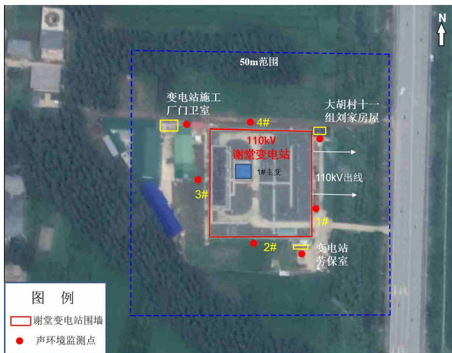
图 5 谢堂变电站及周围敏感点监测布点示意图
