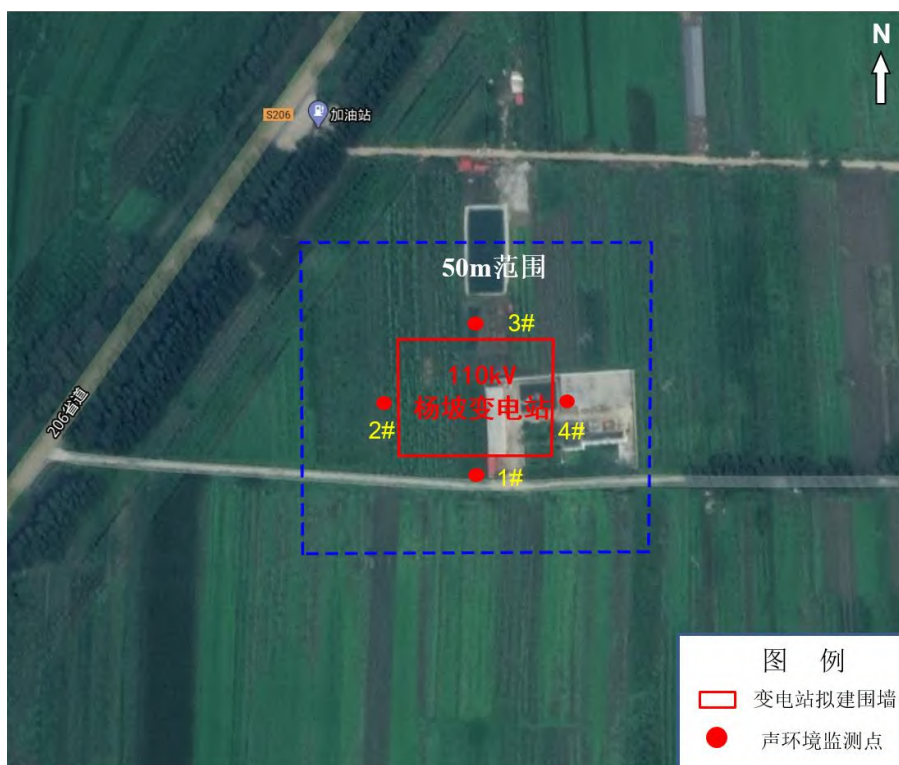
图 5 杨坡变电站站址监测布点示意图
