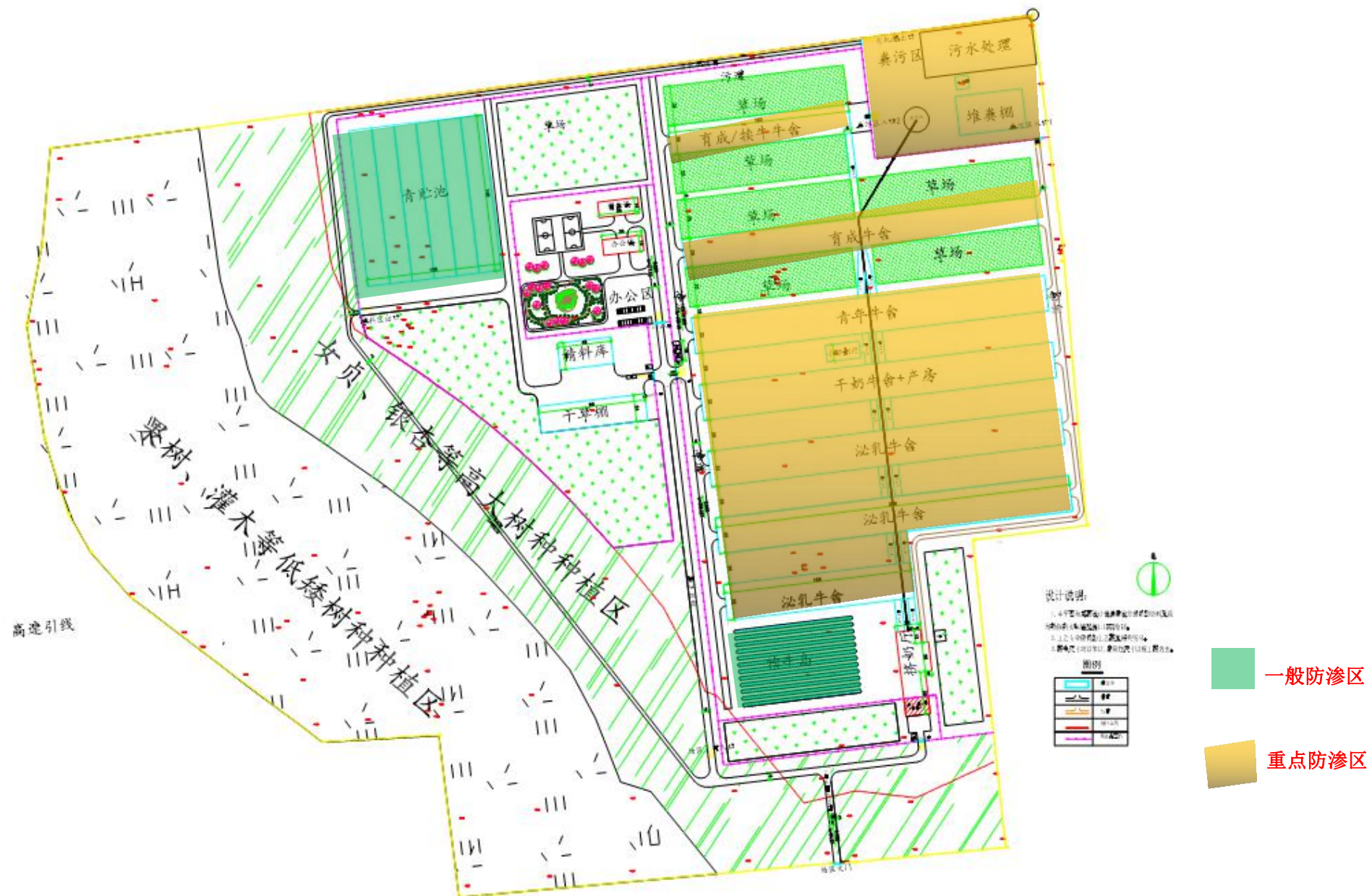
附图 5 项目场区平面布置及防渗分区示意图
