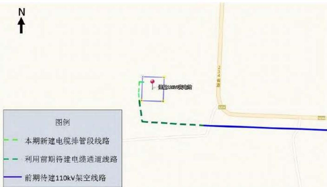
图 2 本工程电缆段线路路径示意图
