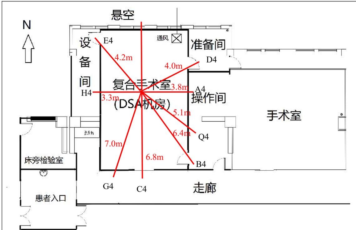
图 11-1 (2) 本项目 1 号楼三层关注点位置剂量率计算平面示意简图
