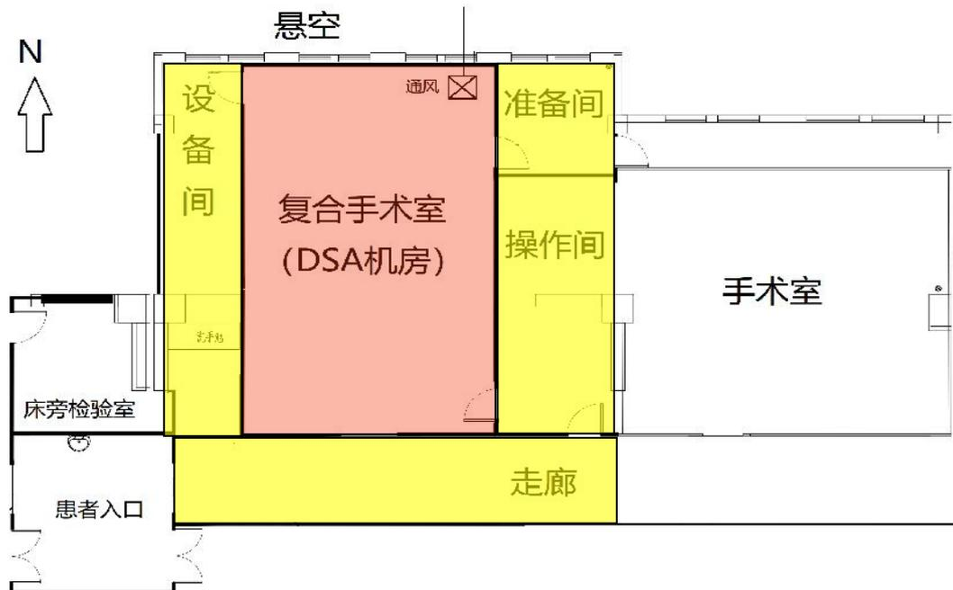
图 10-1(2) 1号楼三层数字减影血管造影机机房分区图
