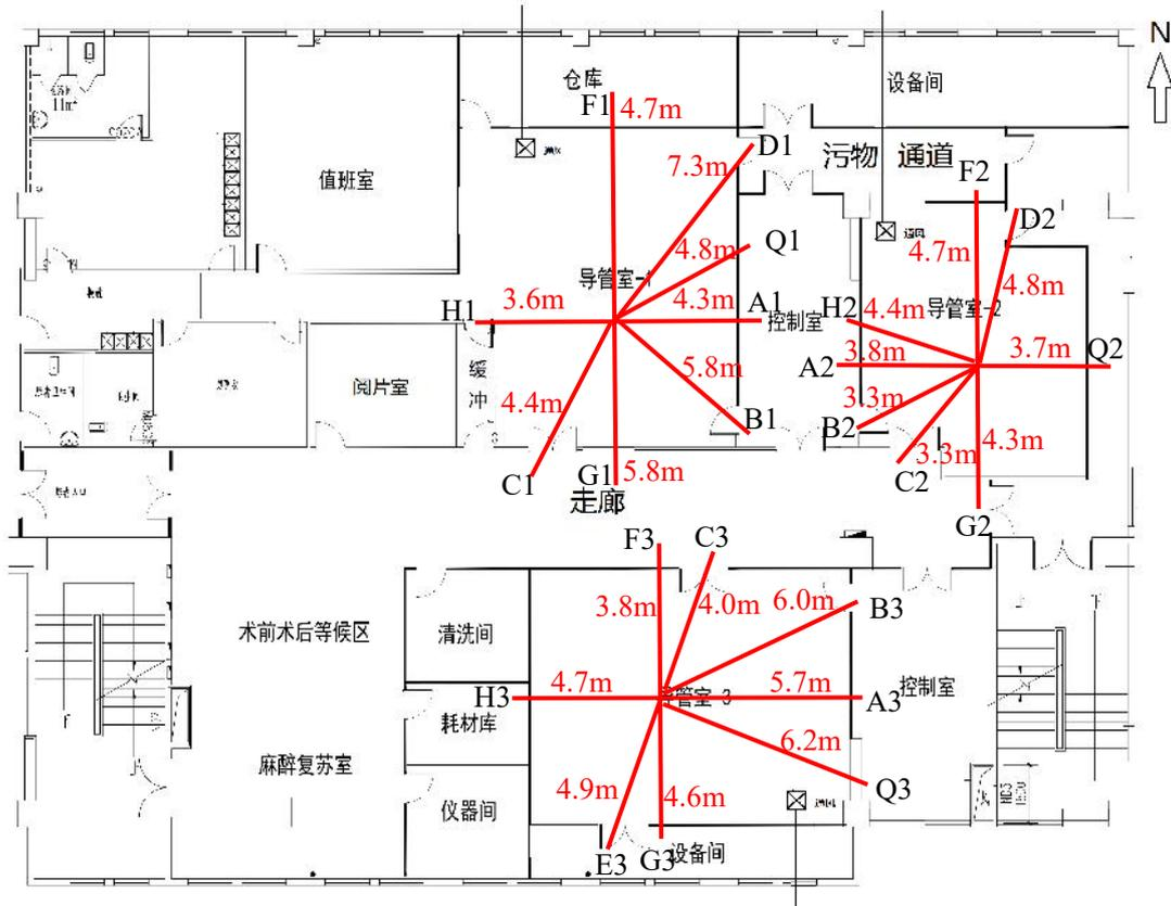
图 11-1 (1) 本项目 1 号楼二层关注点位置剂量率计算平面示意简图
