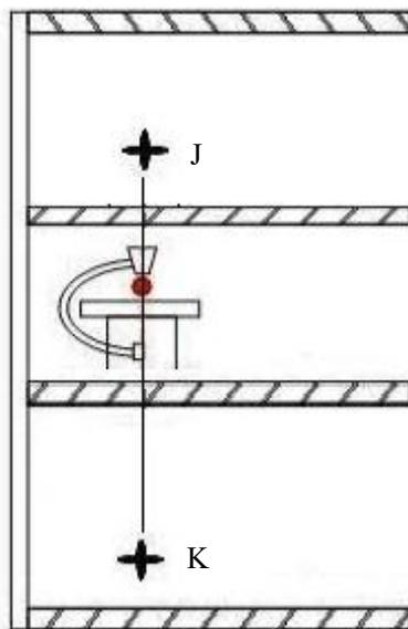
图 11-2 本项目关注点位置剂量率计算示意简图
