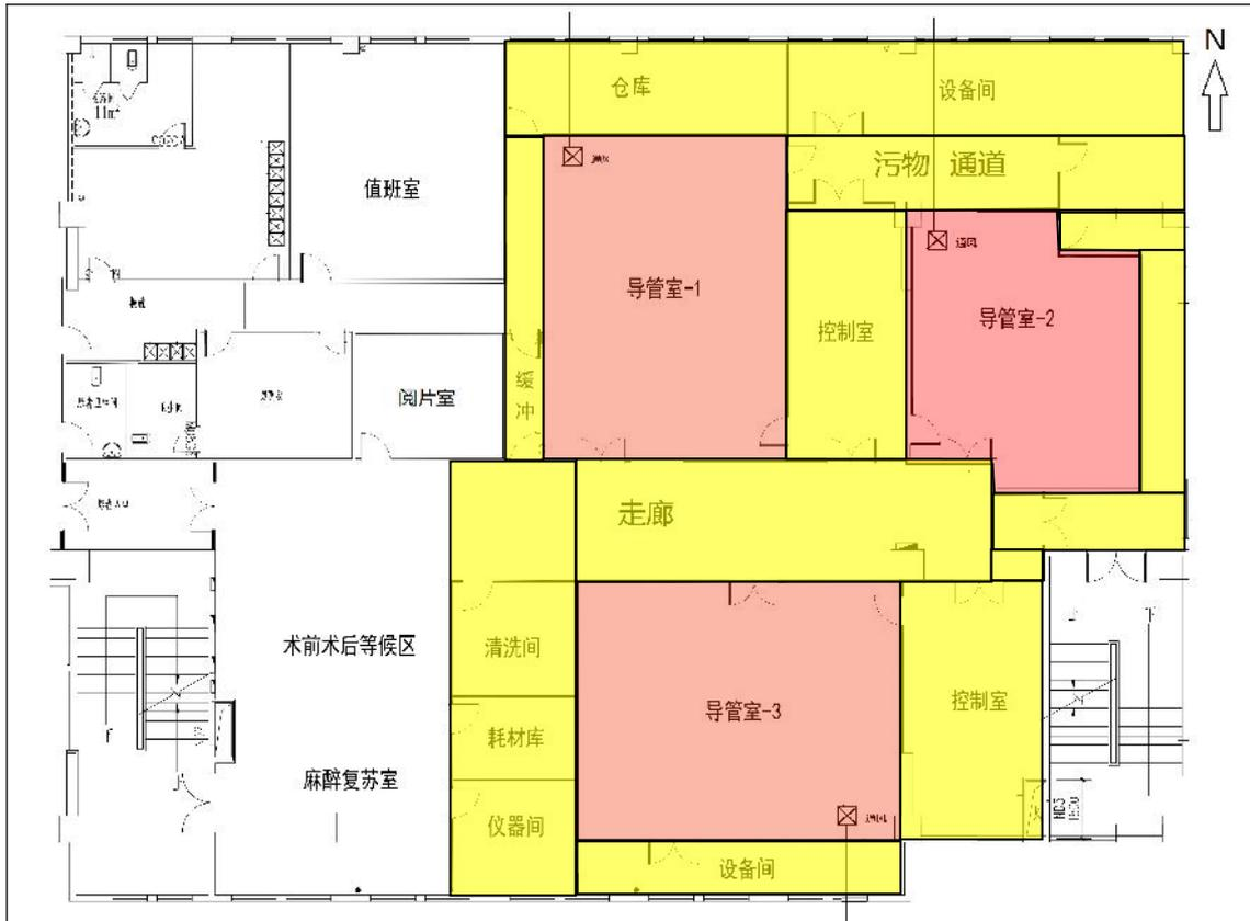
图 10-1(1) 1号楼二层数字减影血管造影机机房分区图
