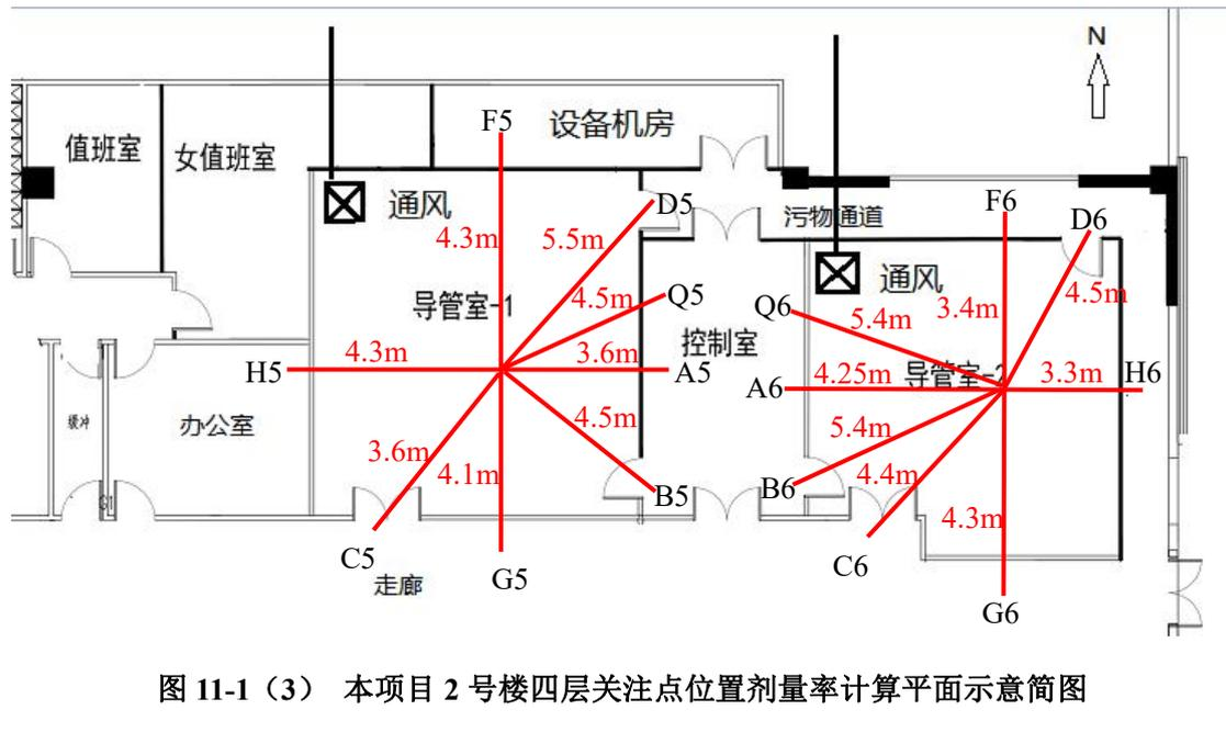
图 11-1 (3) 本项目 2 号楼四层关注点位置剂量率计算平面示意简图
