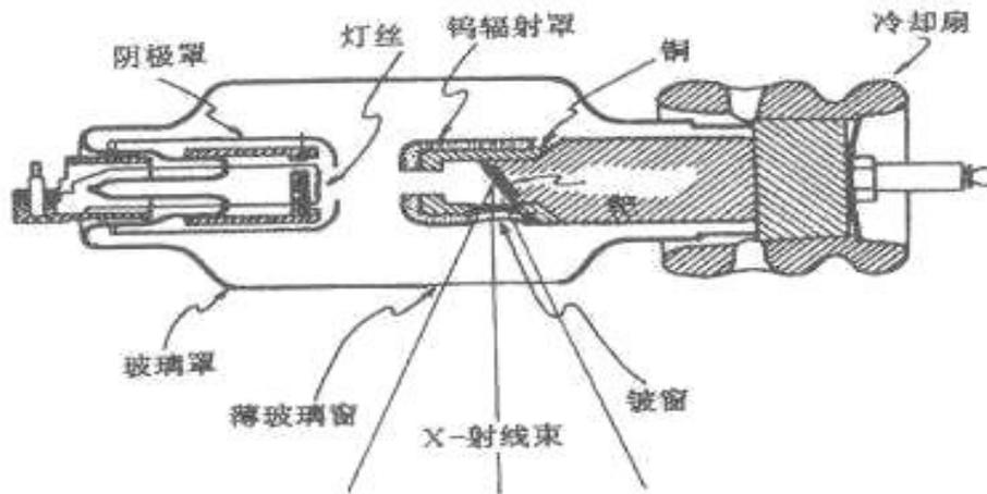
图 9-2 典型 X 射线管示意图
