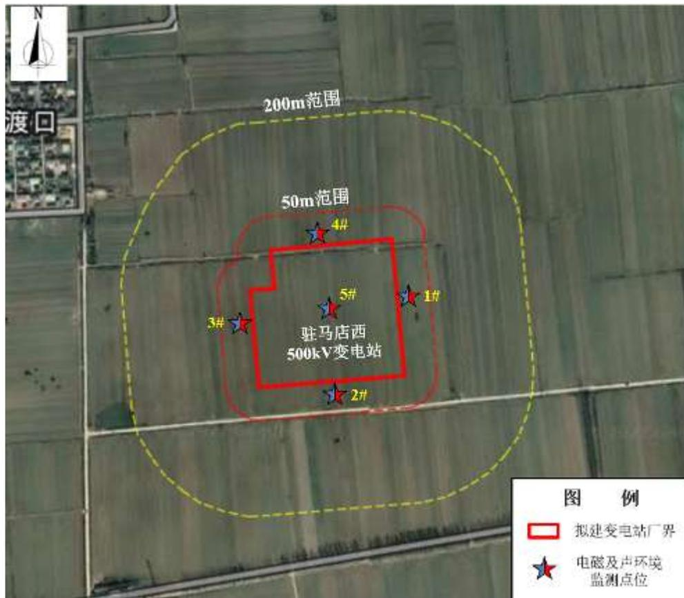
图 4-4 驻马店西变电站电磁和声环境质量现状监测布点示意图
