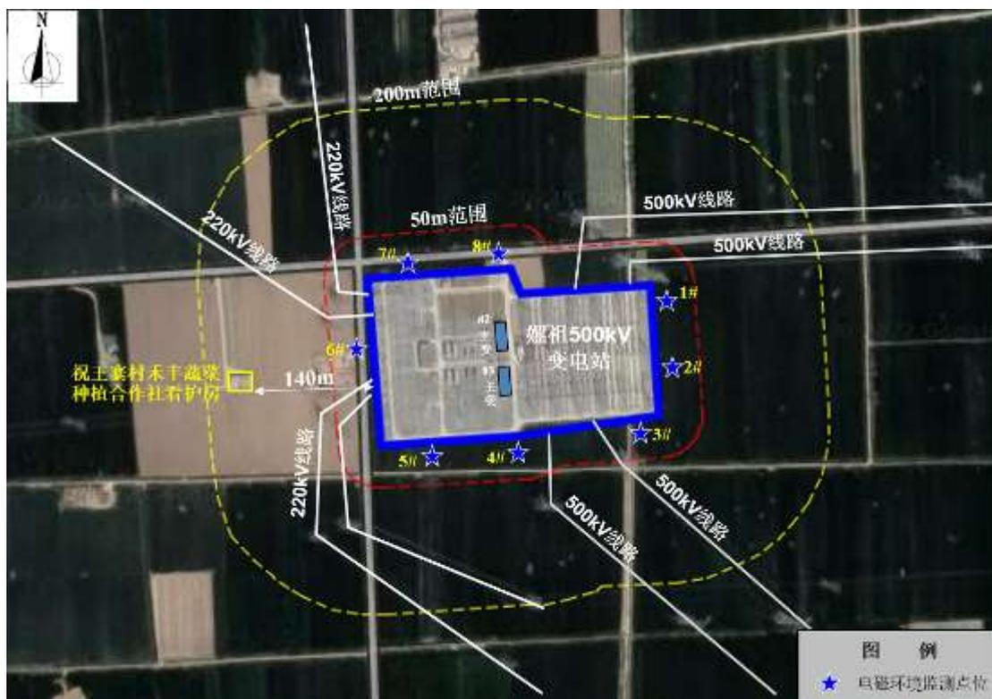
图 4-5 螺祖变电站电磁环境质量现状监测布点示意图
