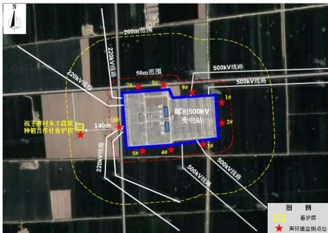
图 4-7 螺祖变电站声环境质量现状监测布点示意图
