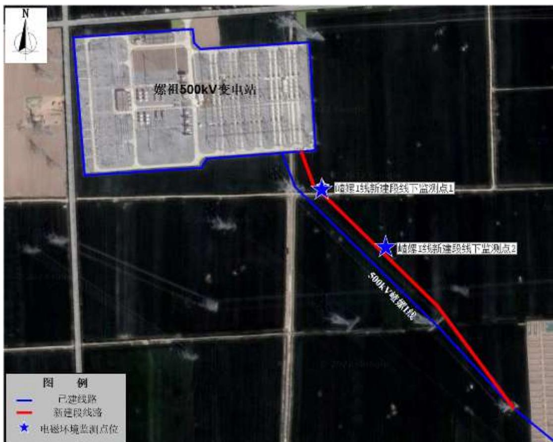
图 4-6 嵯螺 1 回 500kV 线路改造工程电磁环境质量现状背景值监测布点示意图
