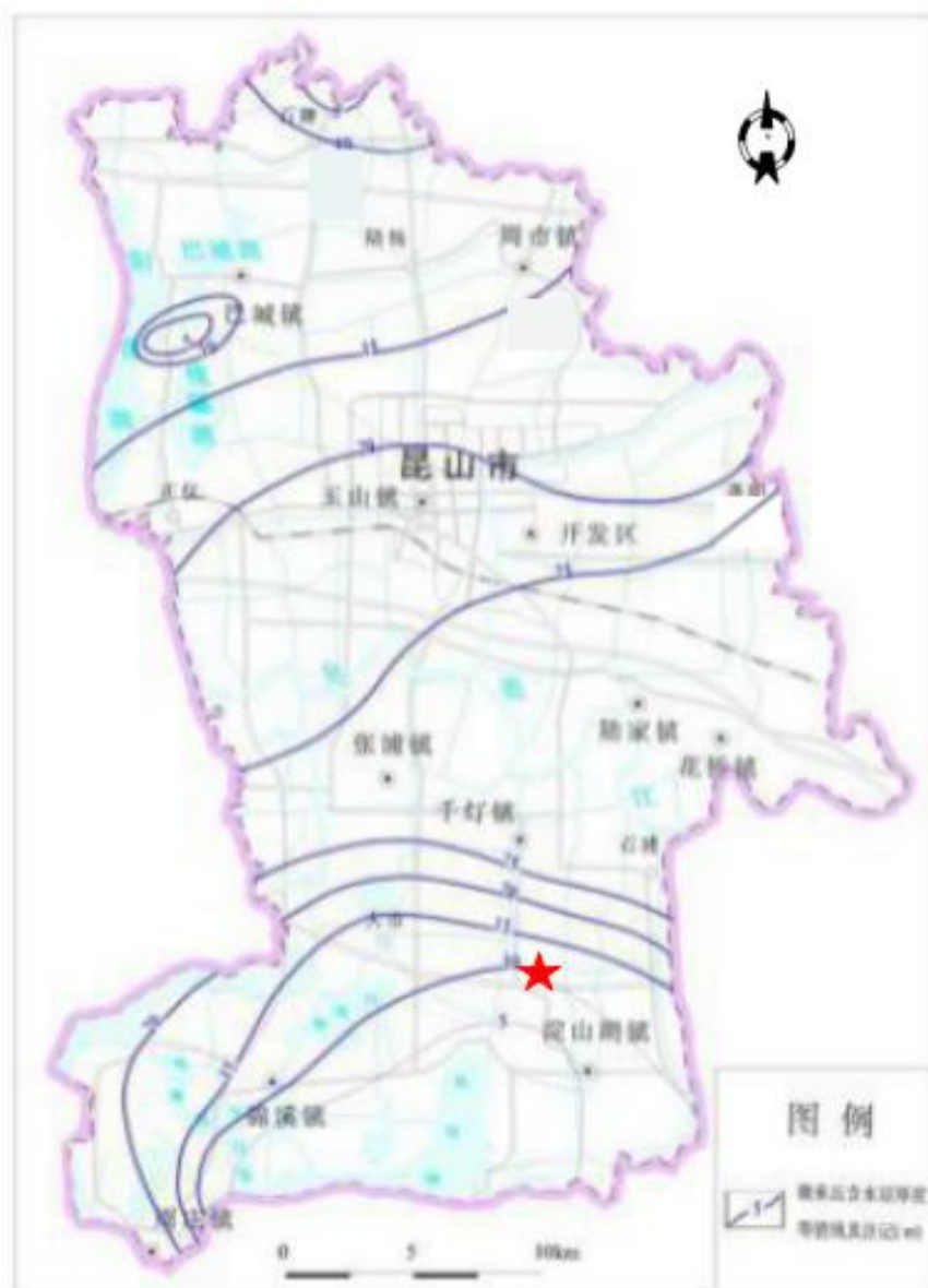
图 3.2-4 昆山市微承压含水层厚度等值线图
