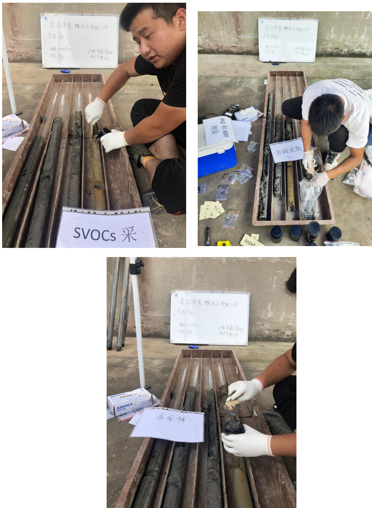
图4.2-7 土壤非VOCs样品取样图
