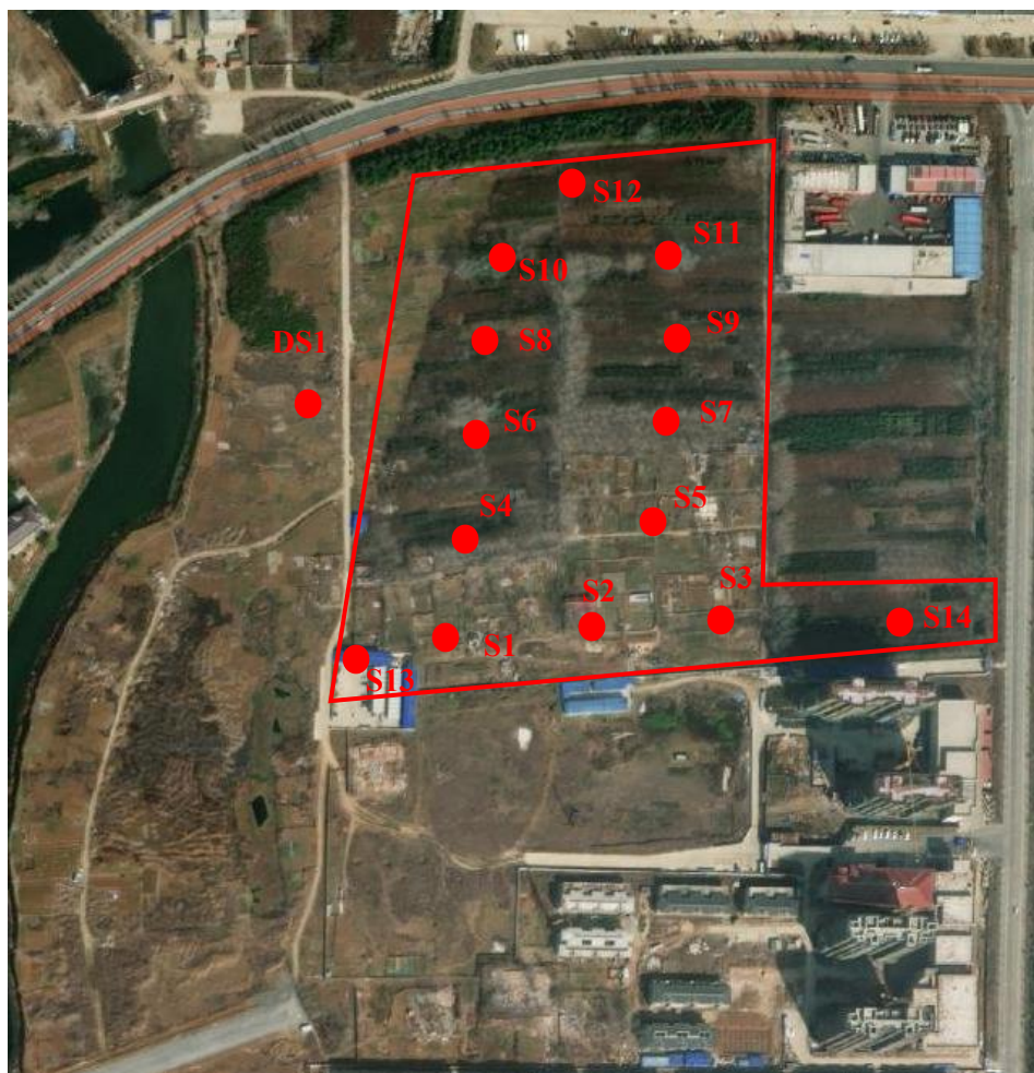
图3.1-1 地块内土壤监测及快速检测点位图
