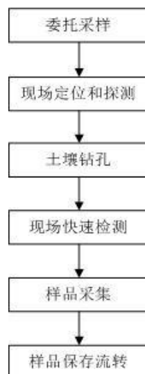
图4.2-1 土壤样品采样流程图
