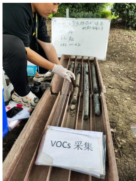
图4.2-5 土壤VOCs样品取样图
