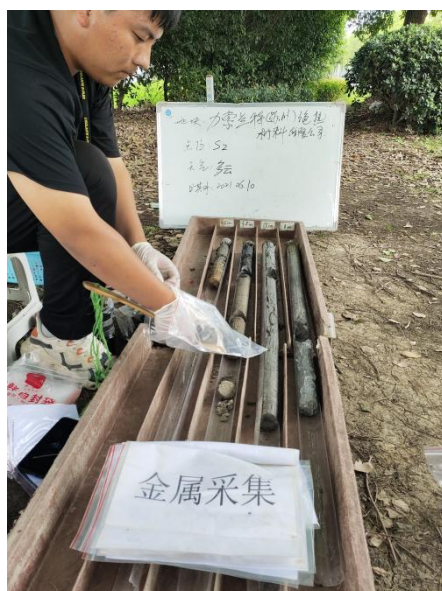
图4.2-7 土壤中金属样品取样图
