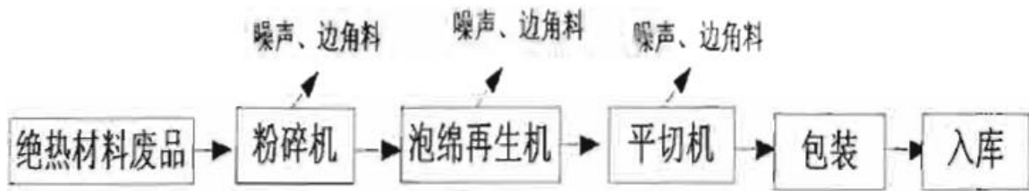
图2.3-9 三期再生泡棉生产工艺流程
