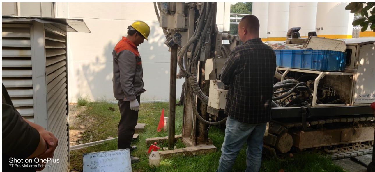
图4.2-2 QY-100L钻孔采样设备现场土壤钻孔
