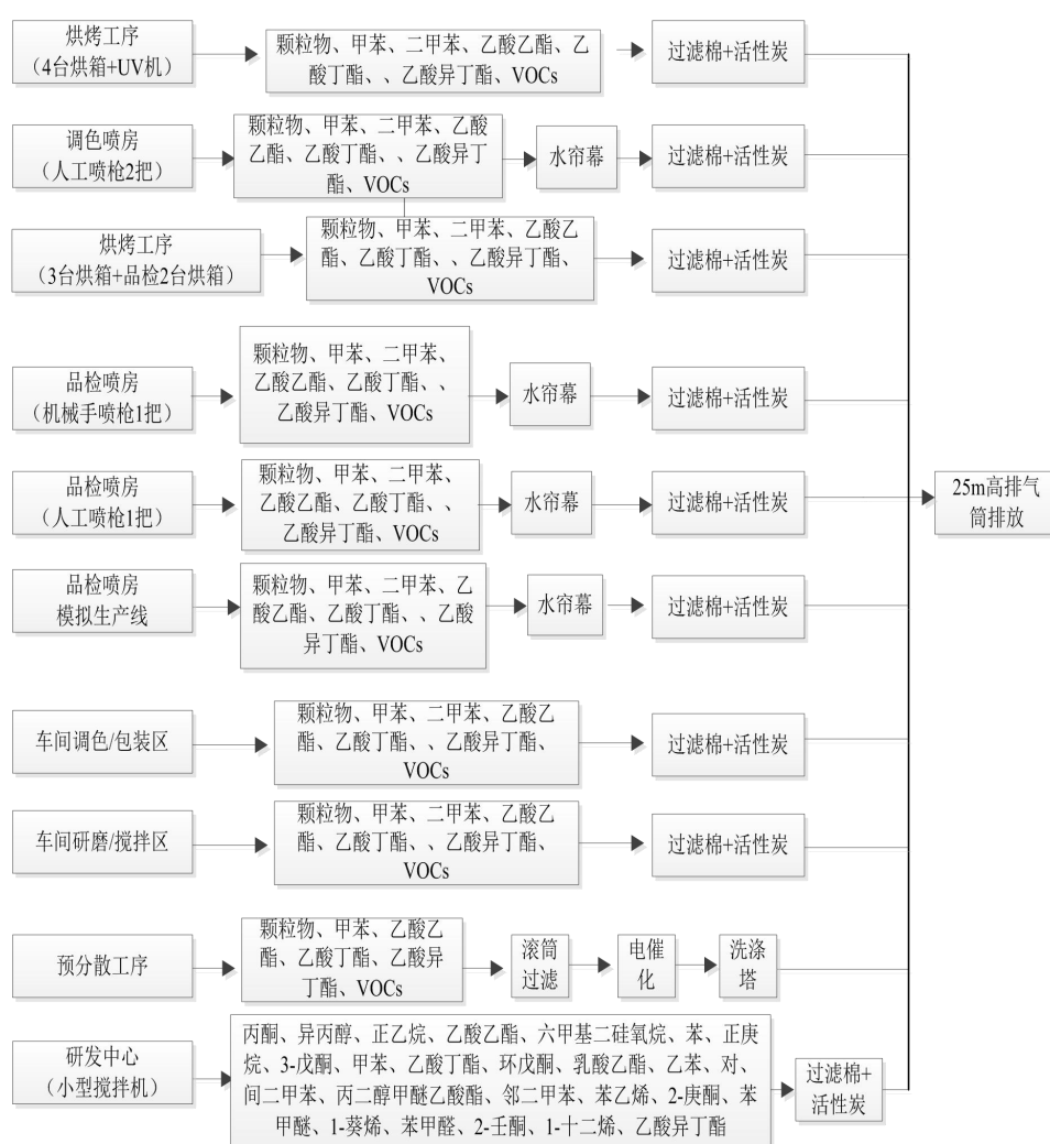
图 2.2-4 废气处理流程图
