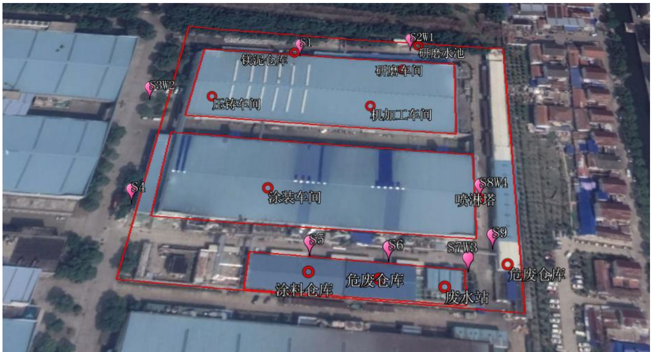
图3.7-1 土壤、地下水监测点位
