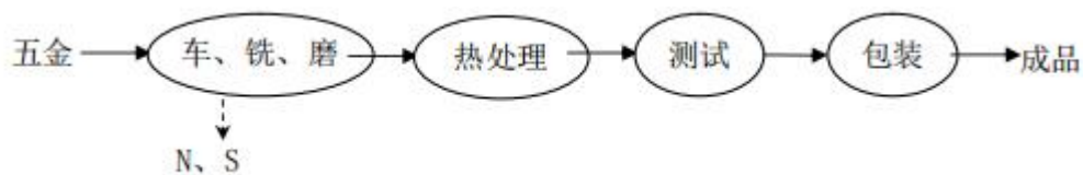
图4.2-1 电子元器件、半导体元器件专用材料生产工艺流程及产污环节图
