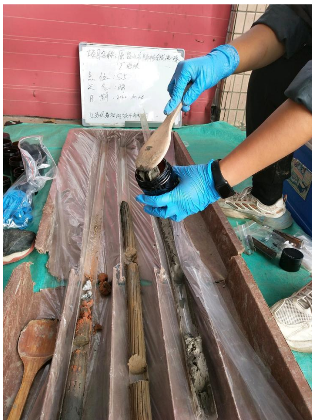
图3.2-6 土壤SVOC样品取样图
