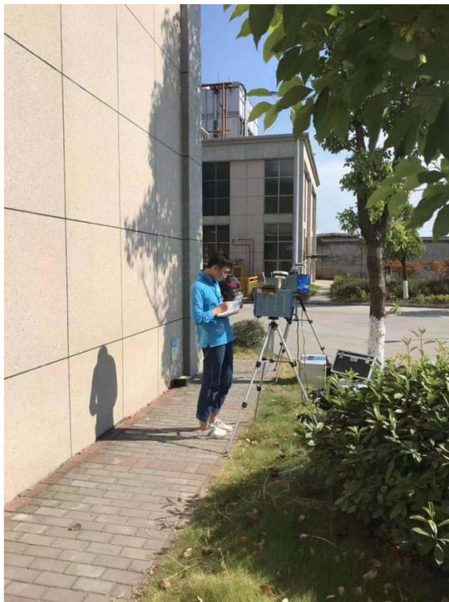
无组织废气监测照片
