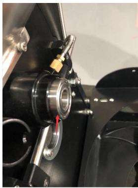
12、换好前轴承之后,调整锅炉的间隙小于 1.5mm(以最小的内六角扳手为基准),再逆序重新安装好拆下来配件
