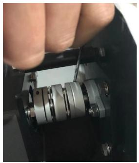
4、用8mm 扳手逆时针旋转拆掉4个螺丝
