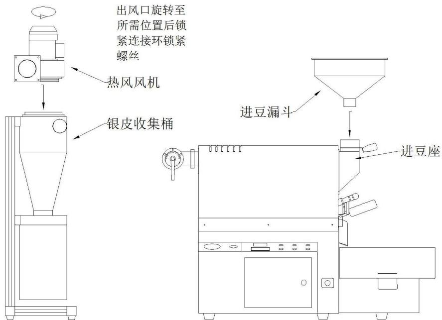
烘焙机安装连接示意图
