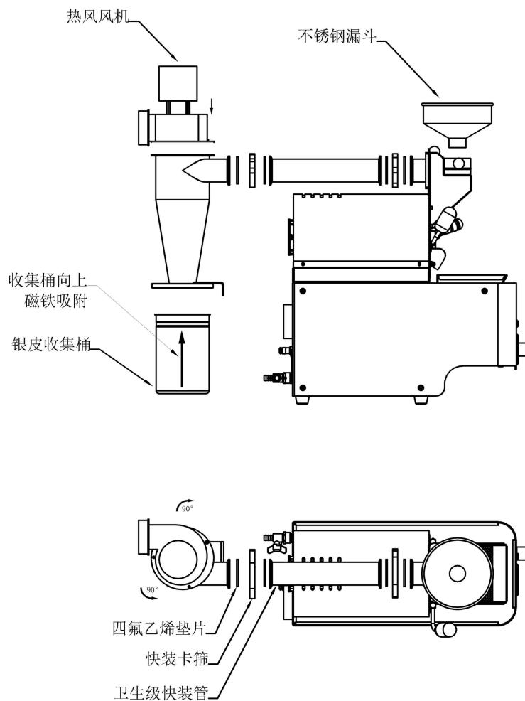
烘焙机安装连接示意图
