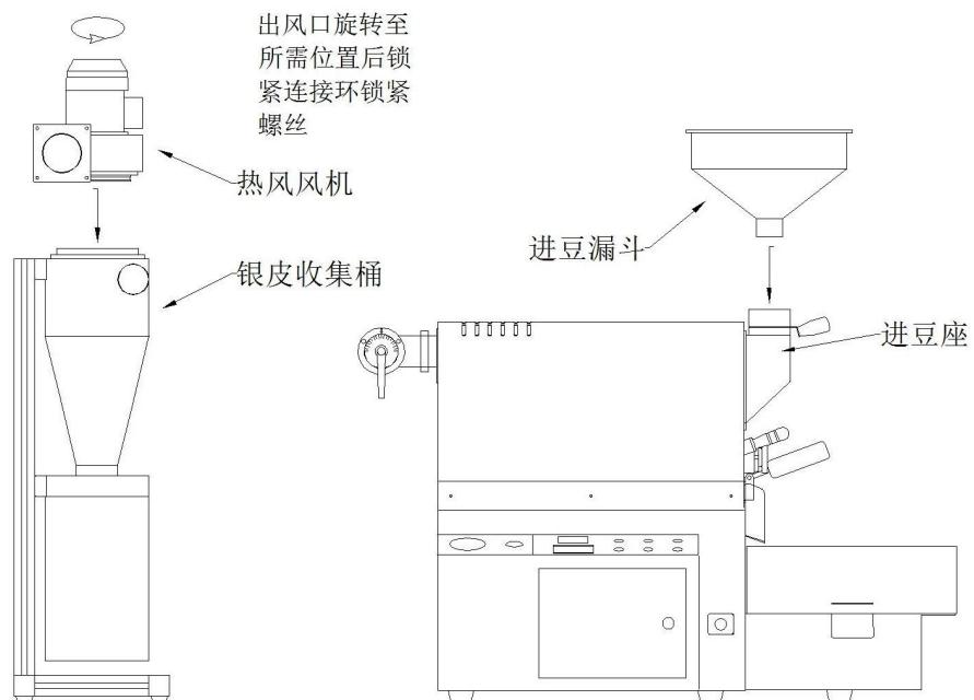
烘焙机安装连接示意图
