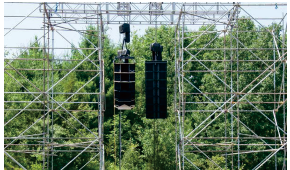
BOSE RoomMatch原型和传统线阵列系统对比测试
