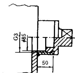
图 2 带有管堵的采样孔
