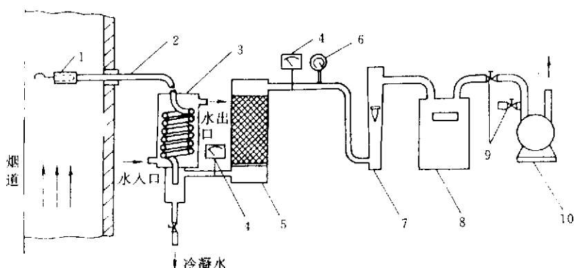
1—滤筒;2—采样管;3—冷凝器;4—温度计;5—干燥器;
