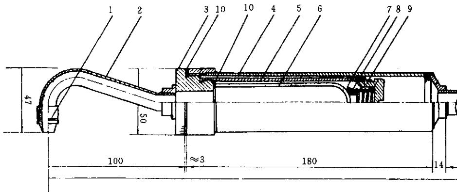
1—采样嘴；2—前弯管；3—滤筒夹前体；4—采样管主体；5—滤筒夹中体；
