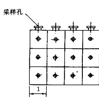
图 6 长方形断面的测定点
