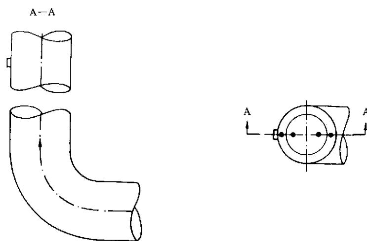
图 8 圆形烟道弯头后的测点
