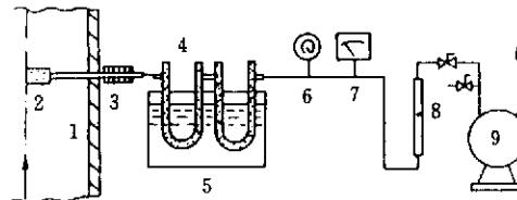
1—烟道;2—过滤器;3—加热器;4—吸湿管;5—冷却水槽;
