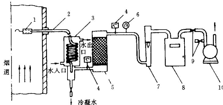
1—滤筒；2—采样管；3—冷凝器；4—温度计；5—干燥器；6—真空压力表；
