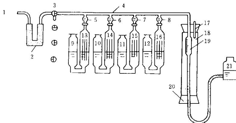
1—进气管；2—干燥器；3—三通旋塞；4—梳形管；5、6、7、8—旋塞；
