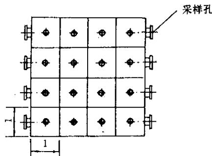
图 7 正方形断面的测定点
