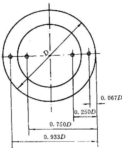
图 9 采样点距烟道内壁距离
