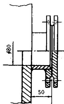
图 1 带有盖板的采样孔
