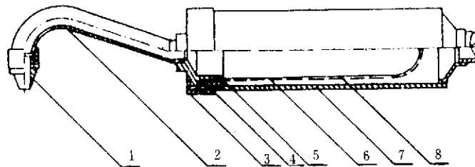
1—采样嘴；2—前弯管；3—滤筒夹压盖；4—滤筒夹；5—滤筒；
