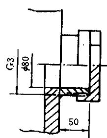
图 3 带有管帽的采样孔
