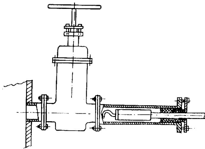
图 4 带有闸板阀的密封采样孔
