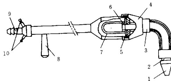
1—采样嘴；2—内套管；3—取样座；4—紧固联接套；5—垫片；6—滤筒压环；
