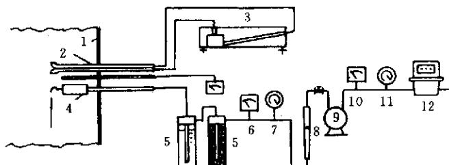
1—烟道；2—皮托管；3—斜管微压计；4—采样管；5—除硫干燥器；6—温度计；7—真空压力表；
