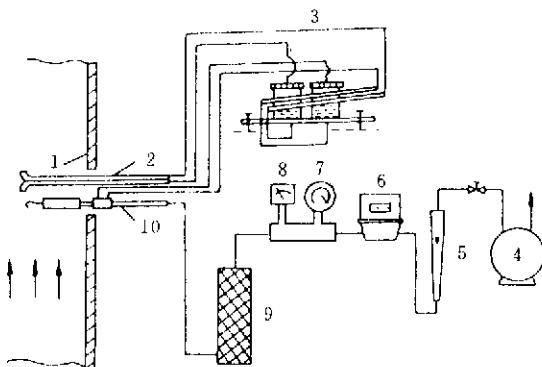
1—烟道;2—皮托管;3—双联斜管微压计;4—抽气泵;5—转子流量计;
