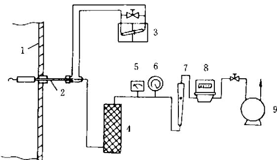
1—烟道;2—采样管;3—压力偏差指示器;4—干燥器;5—温度计;
