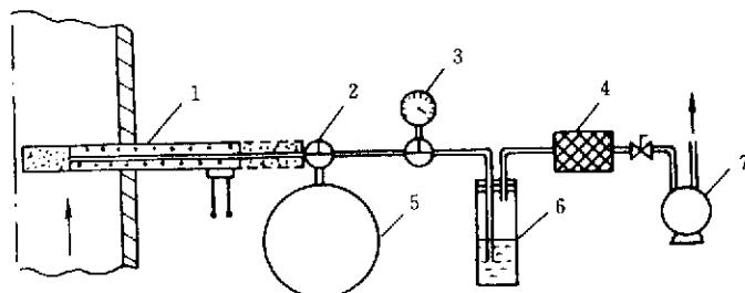
1—加热采样管；2—三通阀；3—真空压力表；4—过滤器；5—真空瓶；
