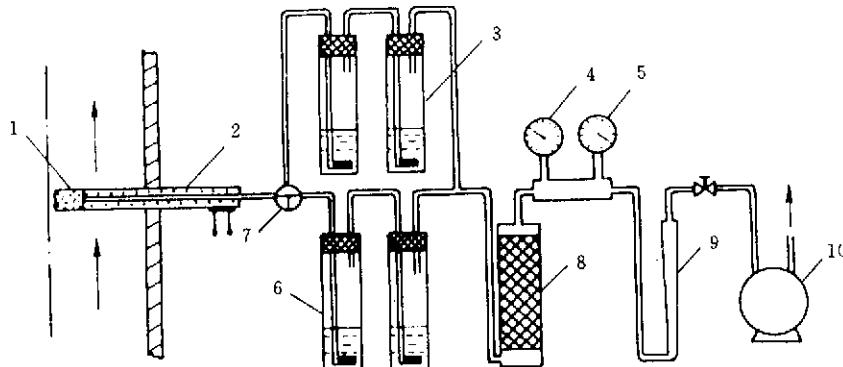
1—烟道；2—加热采样管；3—旁路吸收瓶；4—温度计；5—真空压力表；
