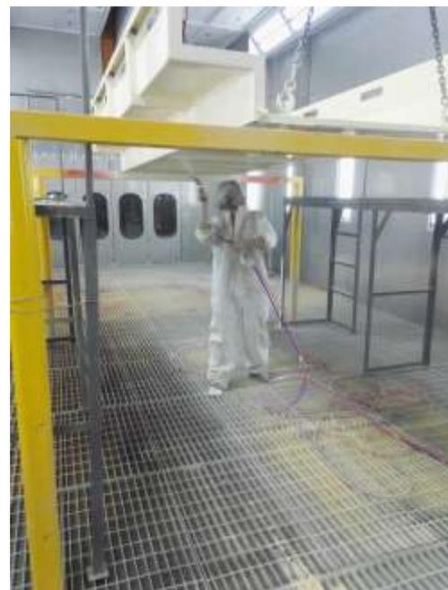
▲油漆种类：1种水性双组份聚氨酯底漆，1种水性双组份聚氨酯面漆(底面共用一个喷房)
