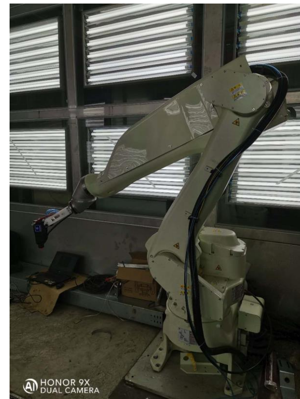
ProMix 2KS 配比系统 *2 , 36:1供漆泵, 川崎机器人+ ProXp水性静电自动混气喷枪
