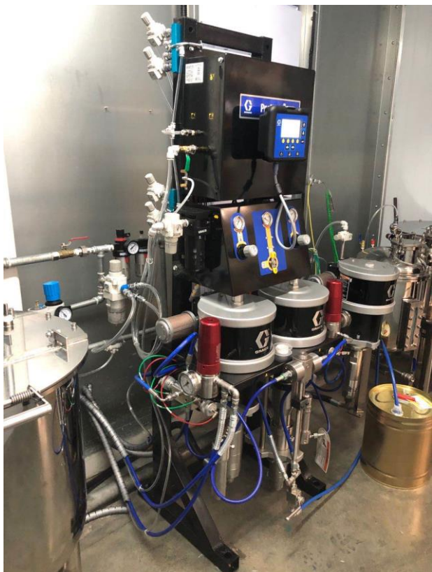
ProMix 2KE 泵计量系统 * 2, 泵压力比35:1, G40手动混气喷枪
