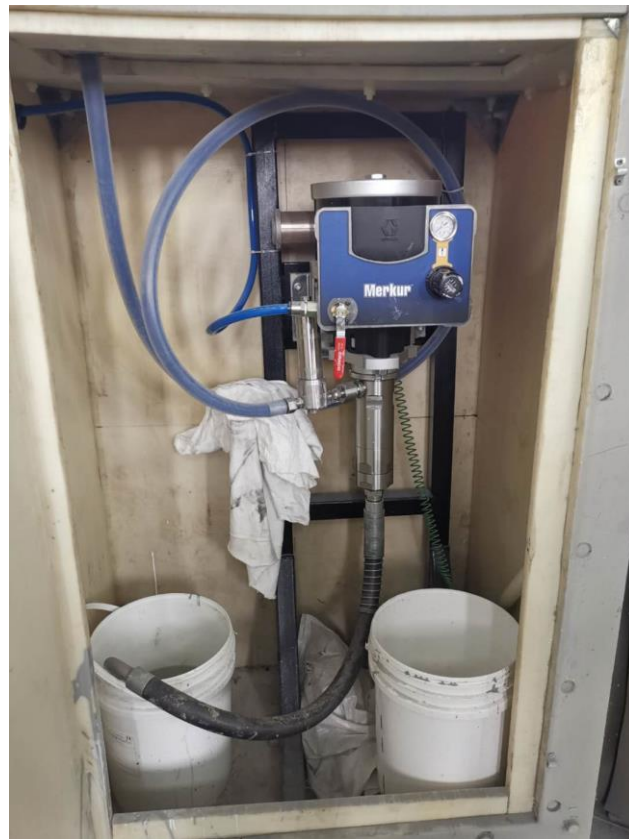
龙门式自动喷涂系统 *1 套 (24:1供漆泵, 15米管路, ProXp AA 60KV 自动水性静电混气喷枪)
