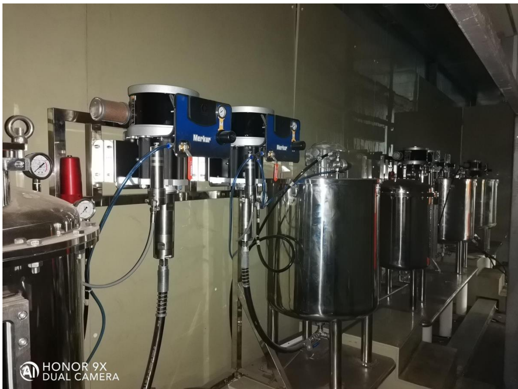
ProMix 2KS 配比系统 *2 , 36:1供漆泵, 川崎机器人+ ProXp水性静电自动混气喷枪
