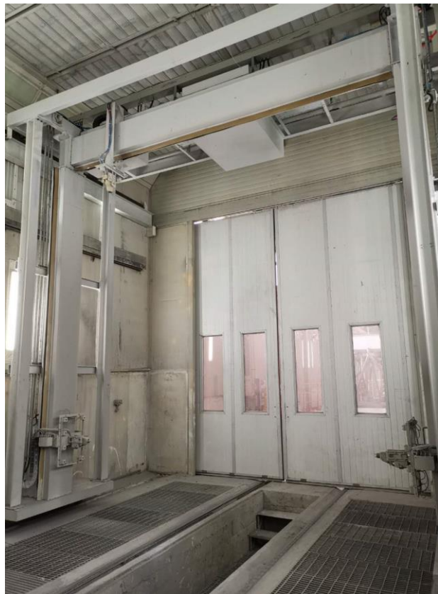
龙门式自动喷涂系统 *1 套 (24:1供漆泵, 15米管路, ProXp AA 60KV 自动水性静电混气喷枪)
