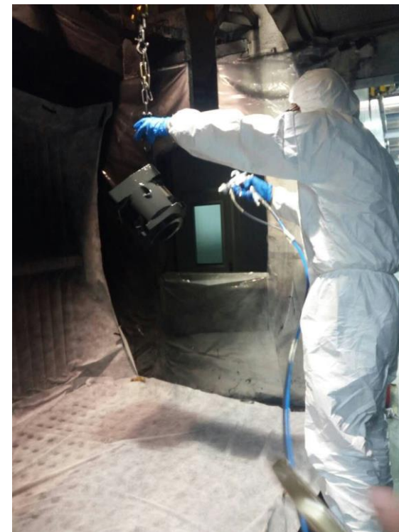
ProMix 2KE 流量计系统 * 1, 两色一固, 4D150中压隔膜供漆泵, AirPro手动水性空气喷枪
