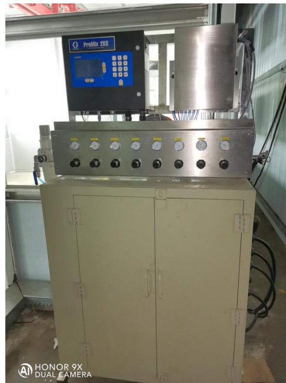
ProMix 2KS 配比系统 *2 , 36:1供漆泵, 川崎机器人+ ProXp水性静电自动混气喷枪
