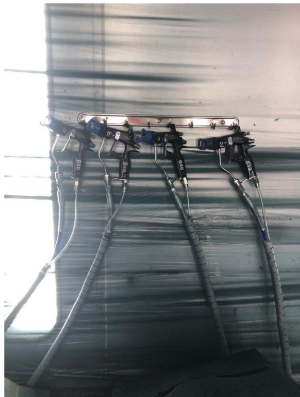
ProMix 2KE 泵计量系统 * 2, 泵压力比35:1, G40手动混气喷枪
