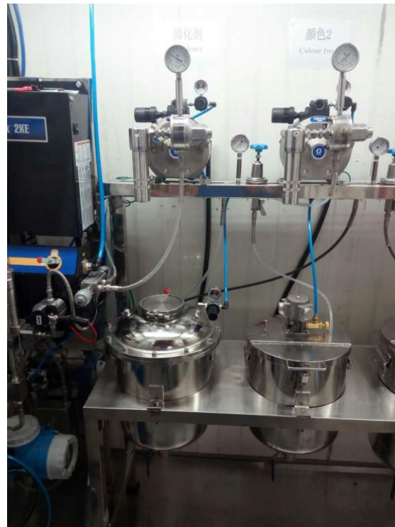
ProMix 2KE 流量计系统 * 1, 两色一固, 4D150中压隔膜供漆泵, AirPro手动水性空气喷枪
