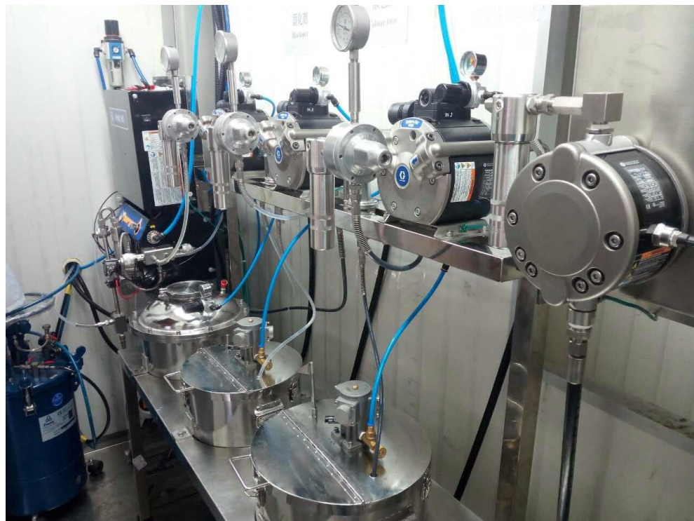
ProMix 2KE 流量计系统 * 1, 两色一固, 4D150中压隔膜供漆泵, AirPro手动水性空气喷枪
