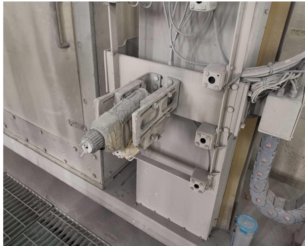
龙门式自动喷涂系统 *1 套 (24:1供漆泵, 15米管路, ProXp AA 60KV 自动水性静电混气喷枪)
