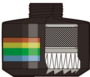
过滤部件均由炭装填层和滤烟层构成。炭装填层以防毒炭为主要原料，而防毒炭以活性炭为基础，浸渍某些金属氧化物制成，依靠其物理吸附、化学吸着和催化作用，对染有毒剂蒸气（气体）的空气进行滤除。滤烟层由滤烟材料（纤维素、石棉以及超细玻璃纤维等）制成，对气溶胶进行过滤。
