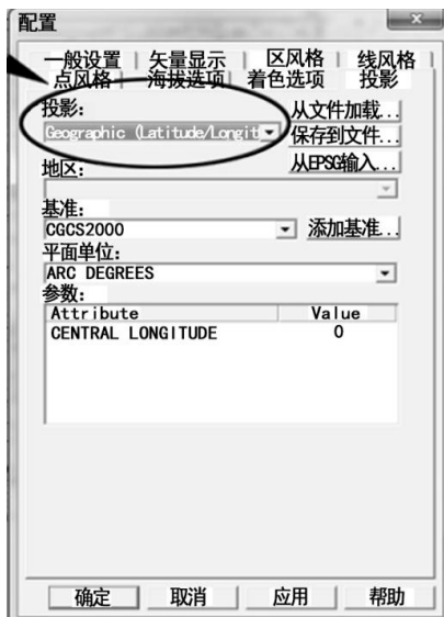
图4 直角坐标到地理坐标投影变换参数配置
