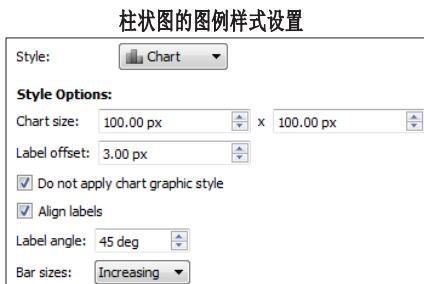
当选择为 Chart 时，对于柱状图，可以设置图例的高度和宽度 (Chart Size)、图例中的文字和图例项的距离 (Label offset)、是否对齐文字标注 (Align labels)、文字标注的角度(Label angle)、图例项的大小是递增还是递减等样式(Bar sizes)。
