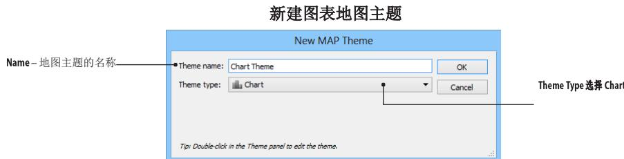
新建后的地图主题会出现在地图主题面板中。双击，弹出编辑图表主题对话框，可编辑图表主题的样式。
