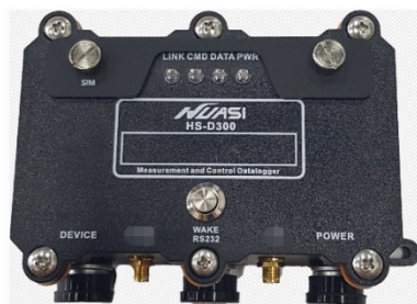
图 5.2-2 综合采集器 D300 实物图
