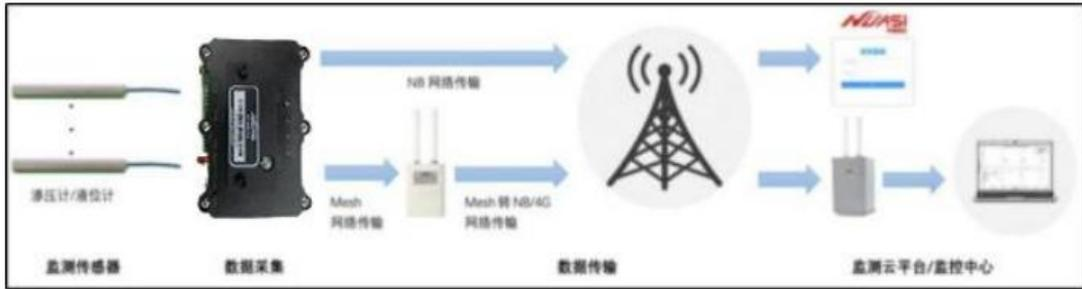
图 3-1 自动化采集系统集成框架图
