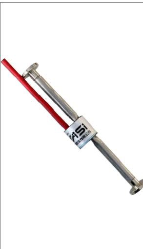
HS-S100型振弦式应变计广泛适用于长期埋设在水工建筑物或其它混凝土结构物（如梁、柱、桩基、挡土墙、衬砌、墩以及基岩等）内部，测量埋设点的线性变形（应变）与应力，同时可兼测埋设点的温度。加装配套附件可组成表面应变计、钢板计、无应力计等多种测量应变的仪器。
