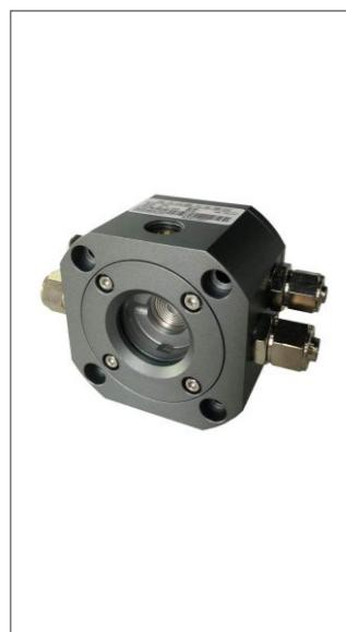
静力水准仪系统是用来测量相对高差变化的一种高精度测量仪器。适用于岩土、结构安全工程长期的多点间的垂直位移监测。设备采用高精密压力传感器测量出相对液位高度。通过基准点与观测点液位的变化量，计算得出沉降量。主要应用在大桥、隧道、桥梁、地铁、大坝、基坑、大型储罐等垂直位移监测。
