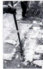
图 3-6 阵列位移計放入测斜管
