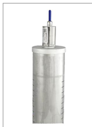
磁致式量水堰计适用于长期测量河流、湖泊、水库、坝体等堰槽的水位，是监测水位及流量变化的有效监测设备。量水堰计采用磁致伸缩传感器作为液位测量，具有分辨率高、稳定性好、性能可靠、响应速度快、线性测量，绝对位置输出，非接触式连续测量，永不磨损，传感器不用标定及定期维护，输出信号为 RS485 数字量，安装简单方便、工作寿命长等功能。磁致式量水堰计测量系统智能识别参数、智能故障诊断、云平台手机无缝对接。
