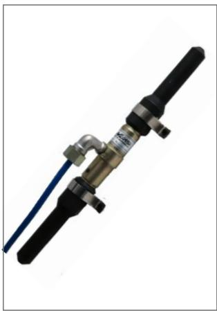
HS-VR200系列型钢筋计，广泛适用于各类建筑基础、桩、地下连续墙、隧道衬砌、桥梁、边坡、码头、船坞、闸门等混凝土工程及深基坑开挖安全监测中、测量混凝土内部的钢筋应力、锚杆的锚固力、拉拔力等。
