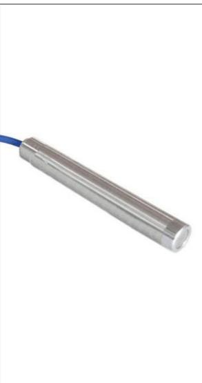
振弦式渗压计适用于长期埋设在水工结构物或其他混凝土结构物及土地内，测量结构物或土体内部的渗透（孔隙）水压力，并可同步测量埋设点的温度。振弦式渗压计加装配套附件可在测压管道、地基钻孔中使用，渗压计为全不锈钢结构， $24 \times 125\text{mm}$ 的灵巧体积，可方便放置在需要测量的狭小部位。振弦式渗压计具有智能识别功能。
