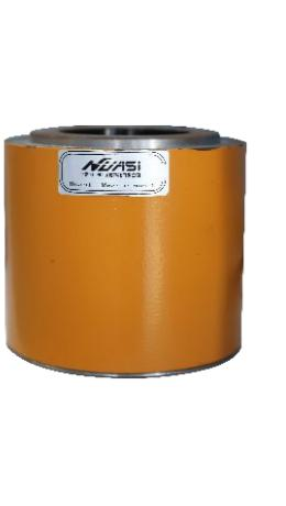
HS-AB系列型振弦式锚索测力计利用特制的应变计作为传感部件，用于长期监测预应力锚索对岩体或建筑物施加压力的大小，无需温度修正，测值准确、性能稳定。使用时，安装在岩石边坡或混凝土建筑物的预应力锚索上。振弦式锚索测力计有二弦、三弦、四弦和六弦。
