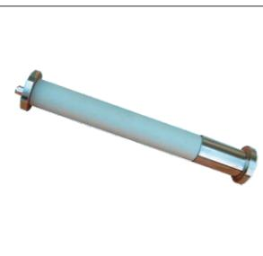
振弦式测缝（位移）计是长期埋设在水工建筑物或其他混凝土建筑物内或表面，用于测量结构物伸缩缝或周边缝的开合度（变形），并可同步测量埋设点的温度。加装配套附件可组成基岩变位计、表面裂缝计、多点变位计等测量变形（位移）的仪器。
