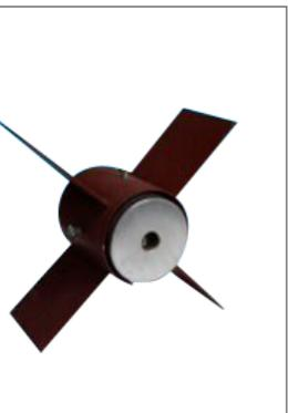
HS-RC型振弦式轴力计，又称反力计，是一种振弦式载重传感器，具有分辨力高、抗干扰性强，对集中载荷反应灵敏、测值可靠和稳定性好等优点，能长期测量基础对上部结构的反力，对钢支撑轴力及静压桩试验时的载荷，并可同步测量埋设点的温度。
