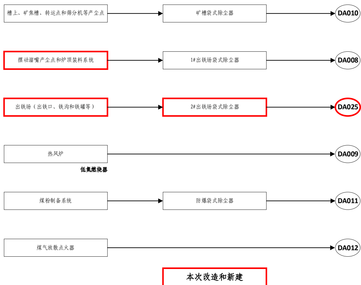
图 6.2-1 本次技改项目废气环保措施收集图
