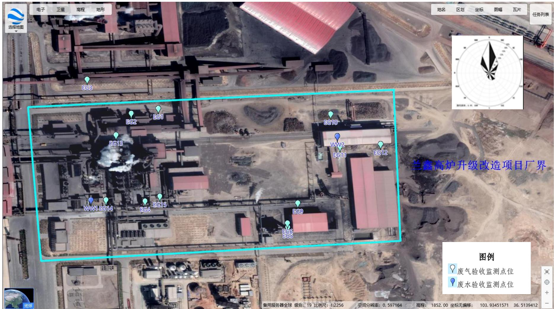
图 6.2-1 高炉升级改造项目废气以及废水污染物排放验收监测点位图
