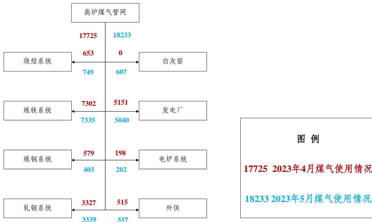
图 3.5-4 本项目环境保护设施调试期间全厂高炉煤气用气平衡图 单位: 万 m<sup>3</sup>
