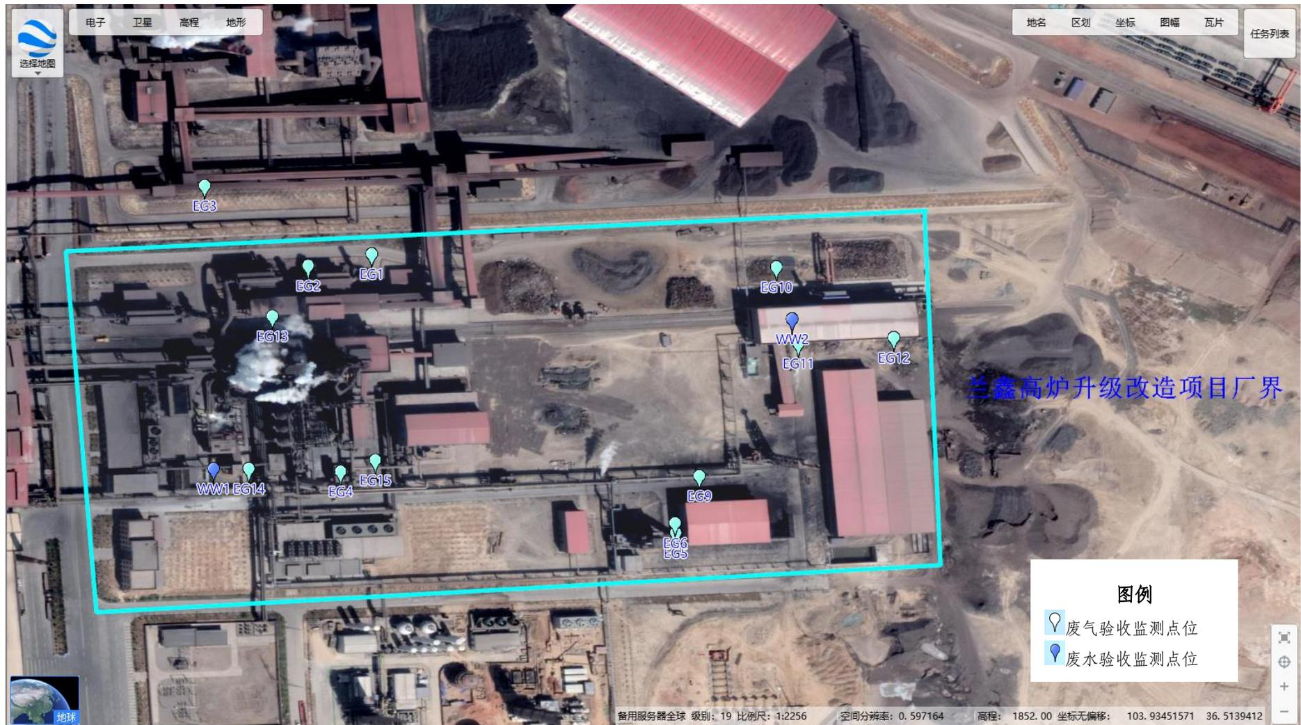
图 4.1-2 本项目废气以及废水污染物排放验收监测点位图
