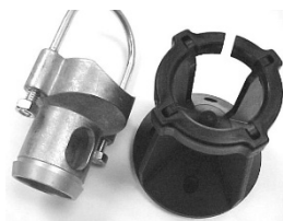
注意喷嘴底部的凸槽轮廓
