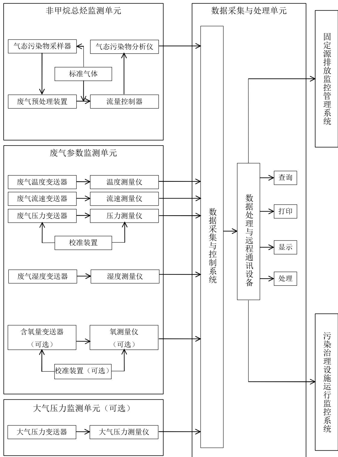
图 1 固定污染源 NMHC-CEMS 组成示意图
