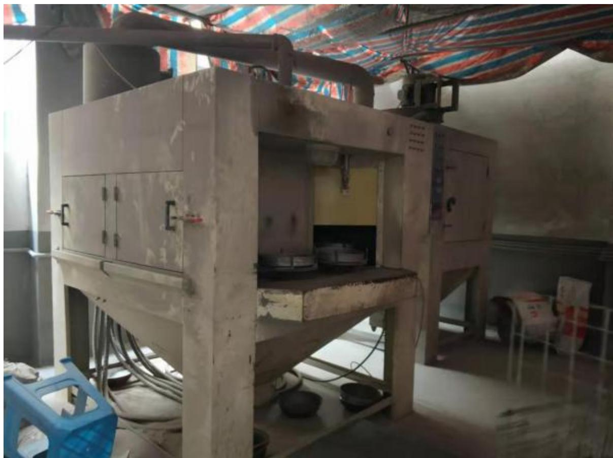
图 4-4 喷砂废气处理装置（布袋除尘）
