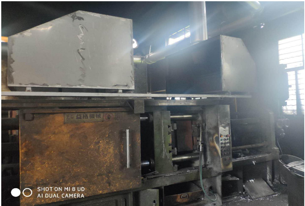
压铸脱模废气产生源及收集装置
