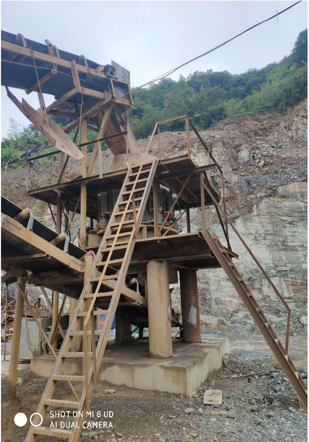
破碎筛分粉尘废气产生源
