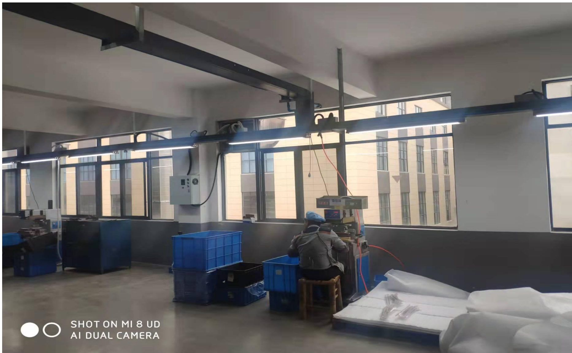
移印废气产生源及收集装置
