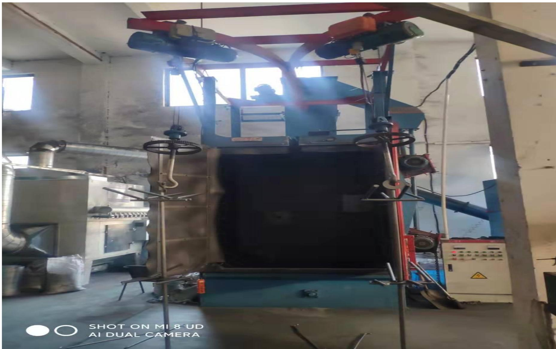
抛丸废气产生源及收集装置（设备密闭收集）
