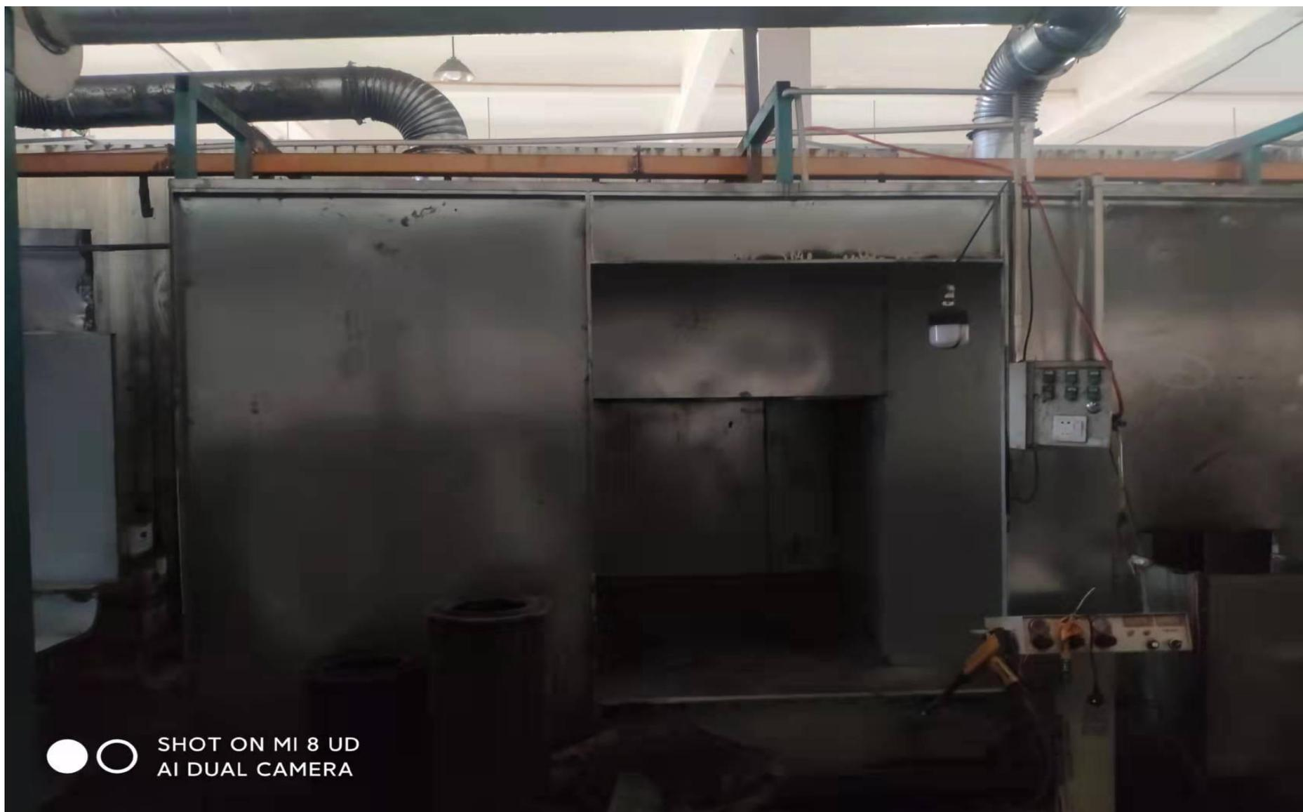
喷塑粉尘产生源及收集装置（设备密闭收集）
