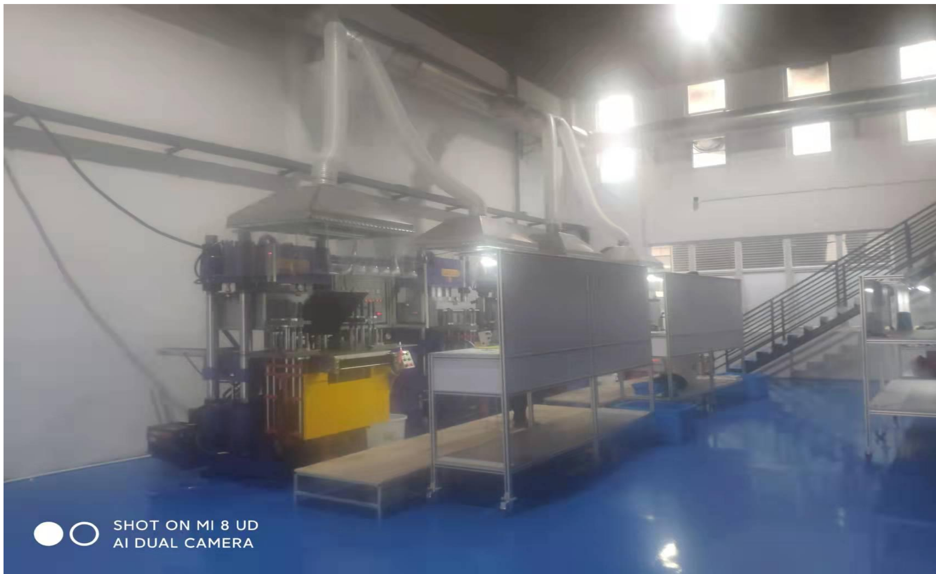
硫化废气产生源及收集装置（集气罩收集）
