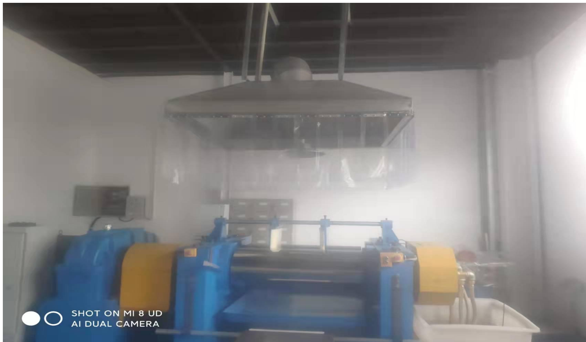
开炼废气产生源及收集装置（集气罩收集）
