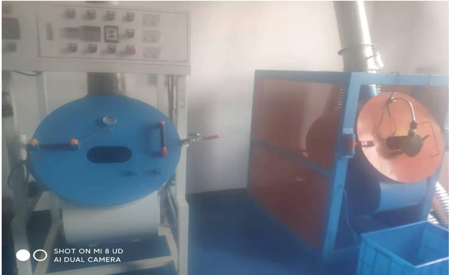
滚喷废气产生源及收集装置（密闭收集）
