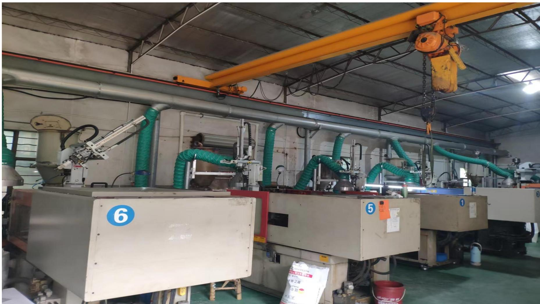
注塑废气产生源及收集装置(集气罩收集)
