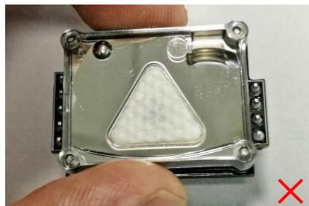
CO<sub>2</sub>传感器是静电敏感设备。请勿赤手触摸传感器。确保操作员使用静电耗散手套。应避免任何将CO<sub>2</sub>传感器暴露于下列气体的可能性，因为它们会降低传感器的性能。
