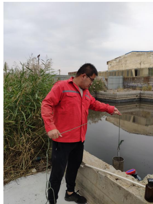
污水处理站进水口采样照片
