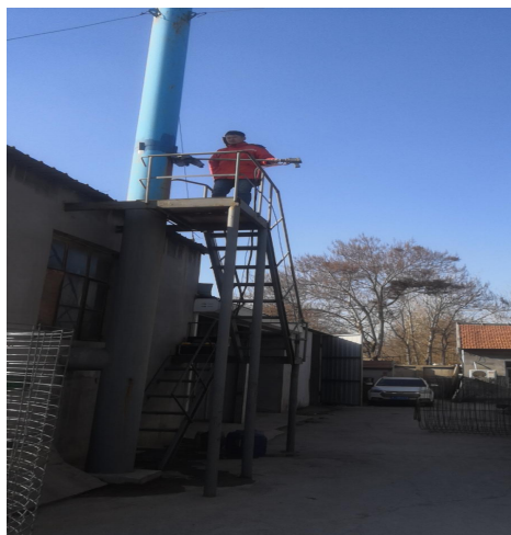
图 2 锅炉出口采样照片
