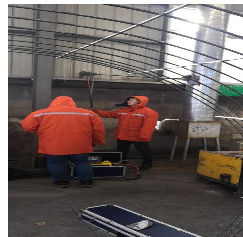
图 3 1#焊接工序排气筒出口采样照片
