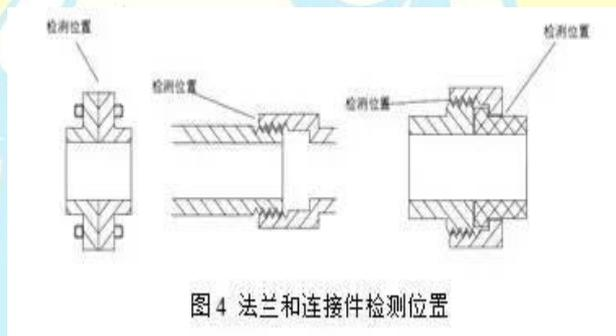
图4 法兰和连接件检测位置
