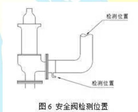
图6 安全阀检测位置
