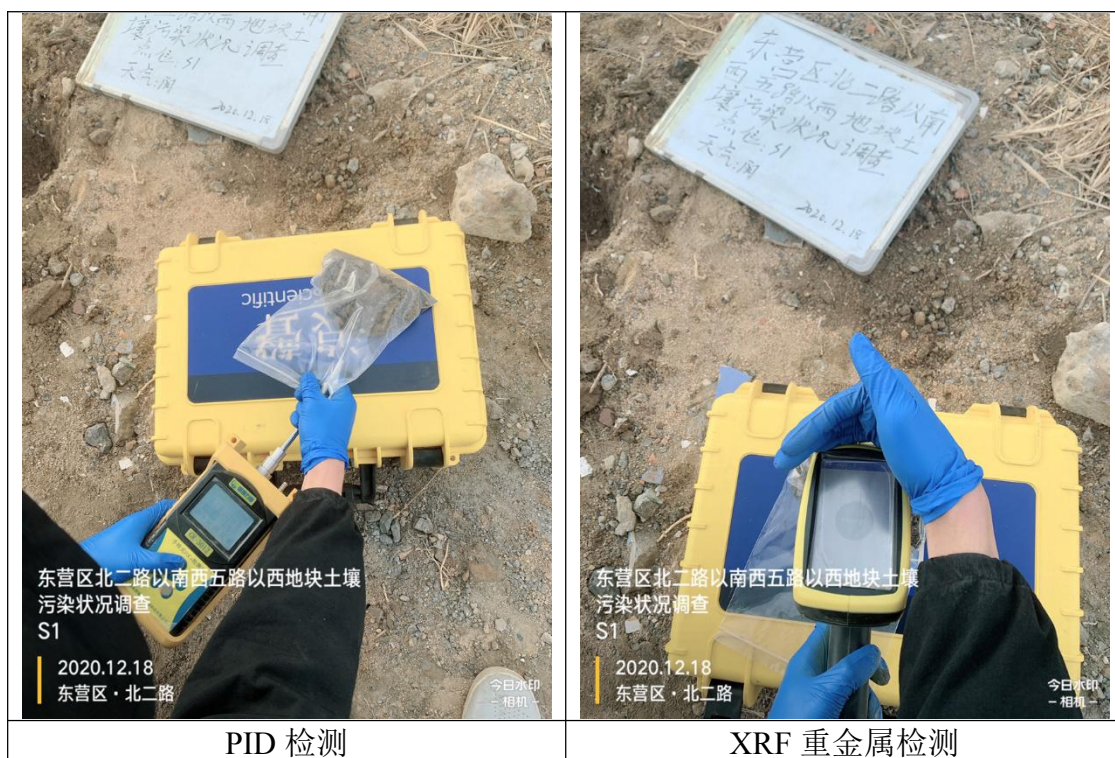
图 5.3-3 快速检测现场照片
