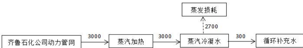
图 2-2 本项目蒸汽平衡图 单位 t/a
